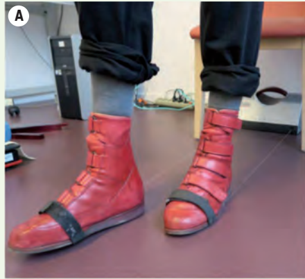
Figure 1. A. Évaluation de la marche avec le Locomètre Satel. Un fil accroché à chaque pied enregistre les principaux paramètres : cadence, symétrie, longueur d'enjambée, temps d'appui et temps de balancement, vitesse. B. Exemple de courbe obtenue avec le Locomètre Satel : mesure de la longueur du pas, de la symétrie, de la vitesse de déplacement (en rouge : jambe gauche ; en vert : jambe droite).
